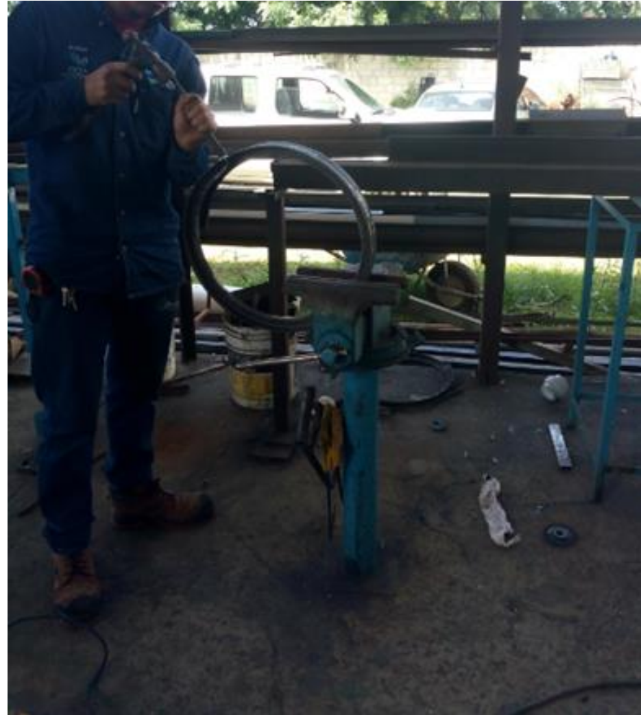
Figura 6. Técnica de hojalatería para eliminar las abolladuras o daños causados por el conformado.
