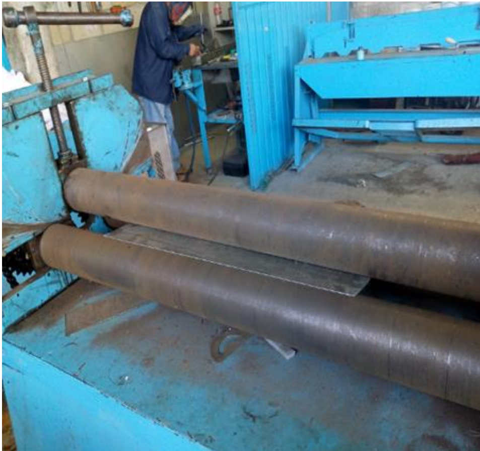
Figura 3. Aproximación al radio de la involuta por medio de una roladora mecánica.
