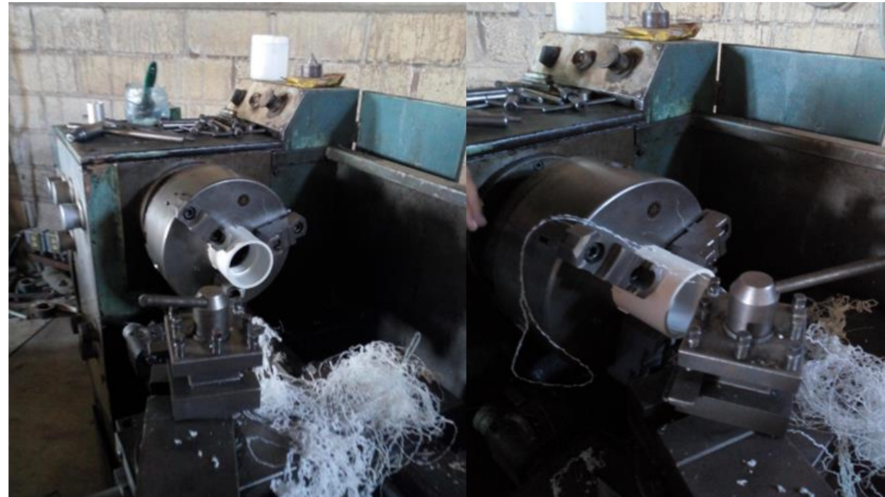
Figura 8. Diseño y maquinado de coples de PVC
