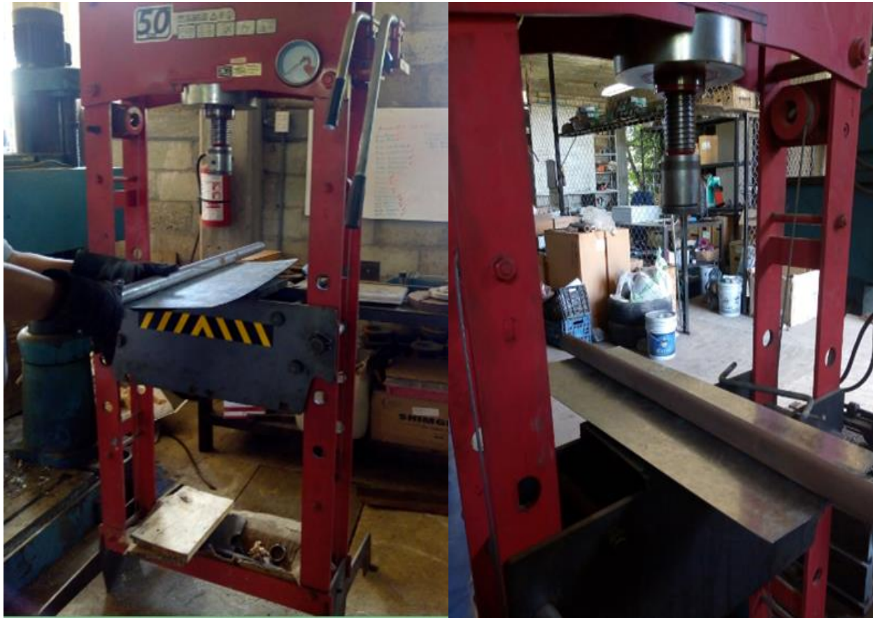
Figura 5. Presión sobre la lámina en una prensa hidráulica de 15 toneladas.
