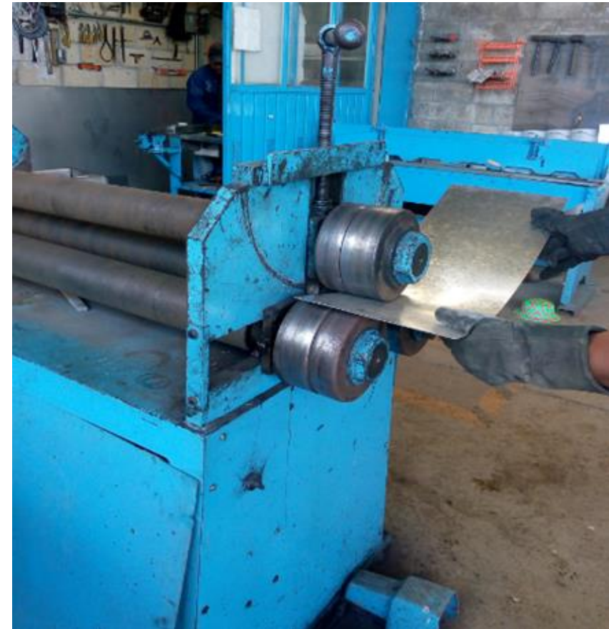
Figura 4. Aproximación al radio de la parábola por medio de una roladora mecánica.
